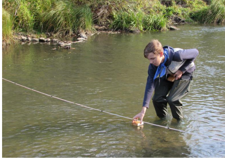
Рис. 2. Андрей запускает поплавок для определения скорости поверхностного течения р. Басандайка
